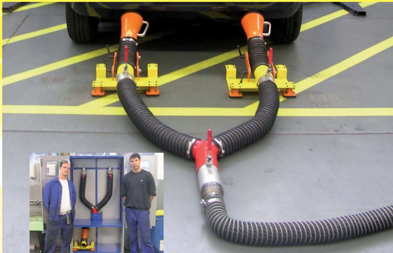
Christian Ulrich und Moritz Schreiber mit dem Abgasadapter in Form eines Y-Stücks.
